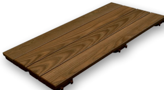
Tavole precomposte accoppiate in TERMO FRASSINO senza zigrinatura antiscivolo. Spess.31 x largh.199 x lungh.795 mm. Con supporto in resina. Pre-composed coupled boards in THERMO-ASH smooth thickness 31 x width 199 x length 795 mm. With plastic resin grid base
