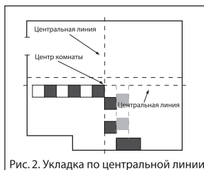
Рис. 2. Укладка по центральной линии
