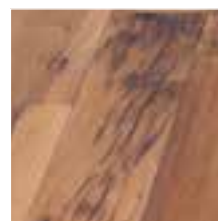
Aspect flammé et gerces Black marks and cracks
