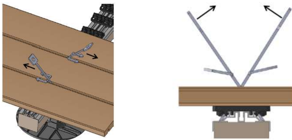
Figura 17, in alto a sinistra : le chiavi vengono azionate facendo leva contemporaneamente. Figura 18: in alto a destra , l'azione crea il distacco delle clips dalla sottostruttura senza compromettere l'integrità di queste (foto Grad™)
