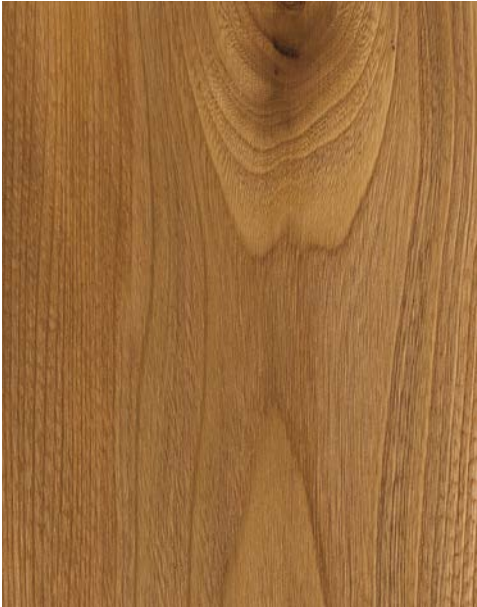
OLMO EUROPEO / EUROPEAN ELM superficie: spazzolato / prelevigato / taglio sega / piallato surface: brushed / polished / saw cut / planed finitura: verniciato finish: varnished
