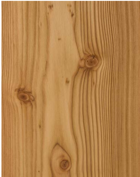
LARICE NATURALE / NATURAL LARCH superficie: spazzolato / prelevigato / taglio sega / piallato surface: brushed / polished / saw cut / planed finitura: verniciato naturale finish: natural varnished
