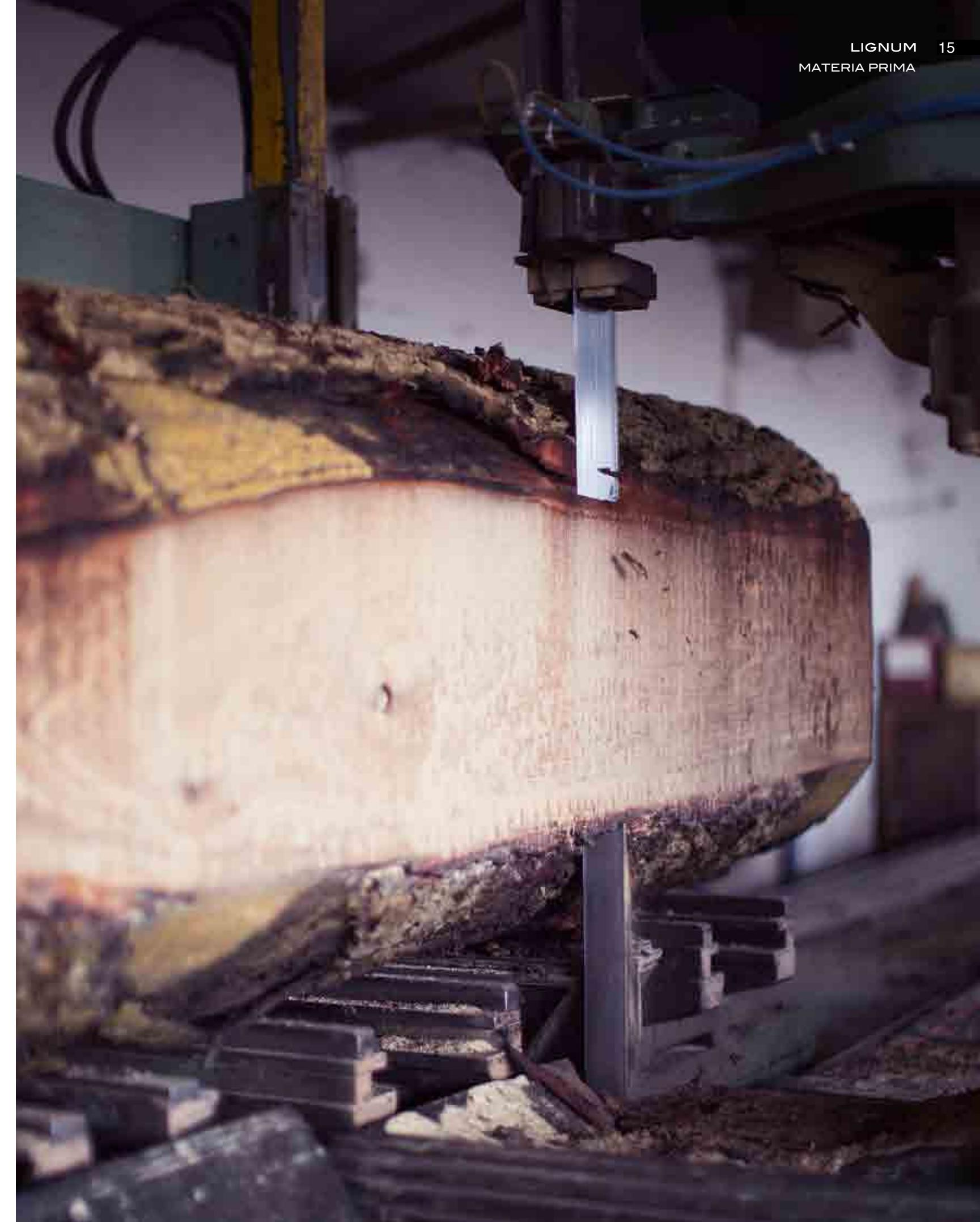
RIFILATURA, CALIBRATURA E SELEZIONE DELLE LAMELLE
